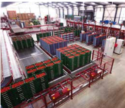
Beispiel eines Ernteverarbeitungssystems für Rispentomaten
